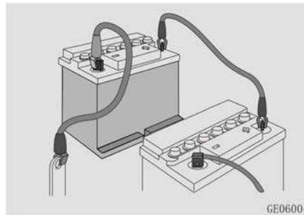
5. При использовании автомобиля для запуска, после подключения проводов, запустите двигатель этого автомобиля, и оставьте его работать с постоянной скоростью в течении некоторого времени.
