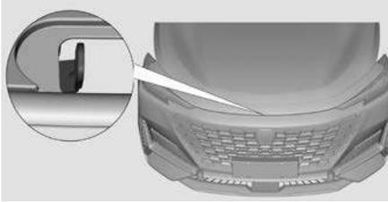
3. Опоры капота двигателя представляют собой пневматические стойки. Для открывания капота двигателя слегка приподнимите его за переднюю часть, и он автоматически откроется и зафиксируется в максимально допустимом открытом положении.
