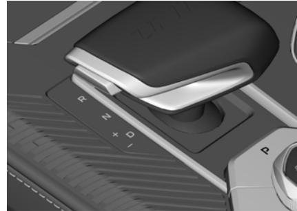
**«P» (Parking)- Парковка.** Положение «P» селектора АКПП – режим стоянки и запуска двигателя:
