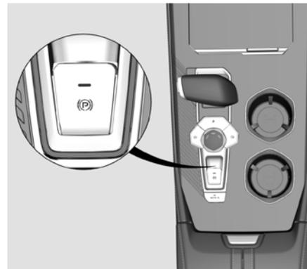
Для снятия автомобиля со стояночного тормоза, сначала нажмите на педаль тормоза, затем нажмите клавишу EPB. Стояночный тормоз разблокируется, и индикаторы на многофункциональном дисплее приборной панели
