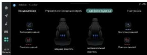
Функция вентиляции сиденья водителя и переднего пассажира может быть включена/выключена через интерфейс мультимедийного дисплея [Настройки автомобиля]- [Кондиционер]- [Удобное сиденье].
