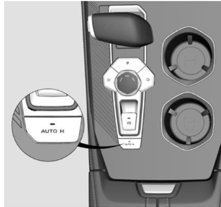
Система автоматического удержания автомобиля (AUTO HOLD) поддерживает давление в тормозной системе с помощью системы ESC и помогает водителю удерживать автомобиль в неподвижном состоянии. При отпускании педали тормоза, автомобиль остается неподвижен. При нажатии на педаль акселератора создается условие для начала движения, стояночный тормоз автоматически освобождается, и автомобиль плавно начинает движение.
