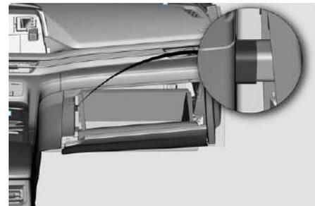
2. Нажмите на кнопку справа, откройте крышку воздушного фильтра салона и извлеките фильтрующий элемент воздушного фильтра салона;
