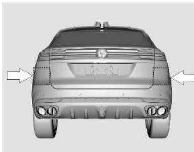
Система зондируется с помощью радиолокационного радара волн миллиметрового диапазона, установленного с обеих сторон внутри заднего бампера.
