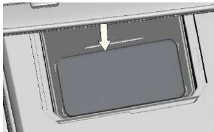
2. Поместите мобильный телефон по центру зарядного устройства и активируйте беспроводное зарядное устройство через интерфейс мультимедийного дисплея автомобиля [Автомобиль]-[Кузов автомобиля]. Зарядка начнется, когда загорится индикатор зарядки.
