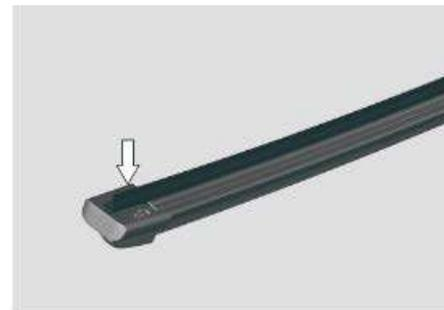
Если щетки стеклоочистителя загрязнены, используйте смоченную мягкую губку для очистки резиновой ленты щетки и ветрового стекла. Сначала воспользуйтесь специальным чистящим раствором или мягким моющим средством для очистки стеклоочистителя и щетки, а затем промойте их чистой водой.
