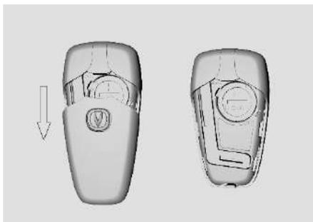
1. Нажмите на заднюю крышку и сдвиньте ее по направлению стрелки.
