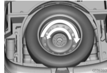
Поверните болт прижимной пластины крепления запасного колеса против часовой стрелки, для извлечения запасного колеса.
