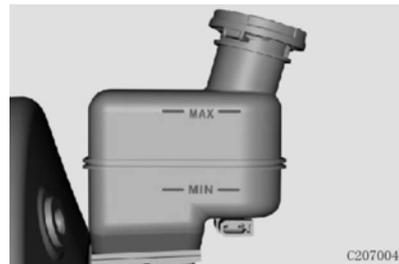
При низком уровне тормозной жидкости, добавьте тормозную жидкость до «MAX» (максимальной) отметки.
