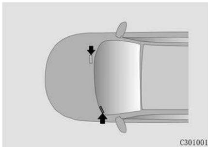
VIN код автомобиля (VEHICLE IDENTIFICATION NUMBER) нанесен в следующих местах:
