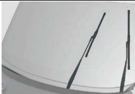
2. Замените щетки стеклоочистителя: нажмите квадратную кнопку/ стопор, фиксирующий щетку стеклоочистителя на рычаге, и снимите щетку стеклоочистителя в направлении, показанном на рисунке.
