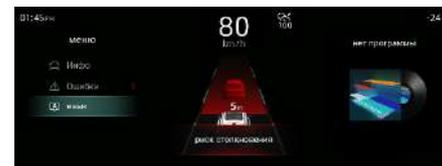
Если опасность столкновения возрастает, то система экстренного аварийного торможения произведет быстрое кратковременное торможение.
