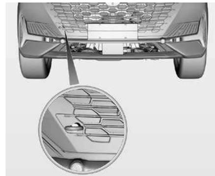
Точка крепления передней буксировочной петли расположена в правой нижней части переднего бампера автомобиля.
