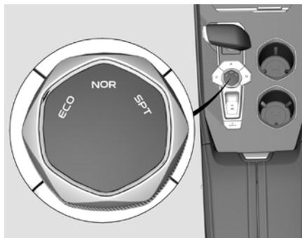
Для выбора режима усилителя рулевого управления, в интерфейсе мультимедийного дисплея выберите [Автомобиль] - [Управление] - [Помощники при движении], и на приборной панели отобразится выбранный режим в соответствии с настройками:
