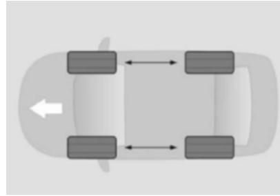
При замене колес проверьте износ тормозных колодок и дисков. После замены колес проверьте и отрегулируйте давление передних и задних шин. Проверьте на соответствие рекомендованным значениям моменты затяжки колесных гаек.
