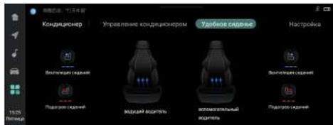
Функция обогрева сидений водителя и переднего пассажира может быть включена/ выключена через интерфейс мультимедийного дисплея [Настройки автомобиля]- [Кондиционер]- [Удобное сиденье].
