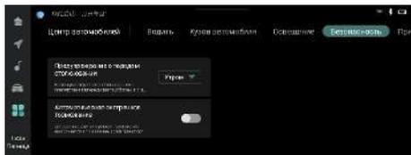
После активации системы ELK, при достижении скорости автомобиля более 40км/ч, система переключится в режим ожидания. Если датчик распознал линии дорожной разметки с обеих сторон, а автомобиль отклоняется к краю полосы движения и существует риск столкновения с встречным транспортным средством
