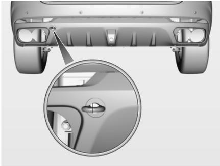
Точка крепления задней буксировочной петли расположена на кузове в левой нижней части заднего бампера автомобиля.
